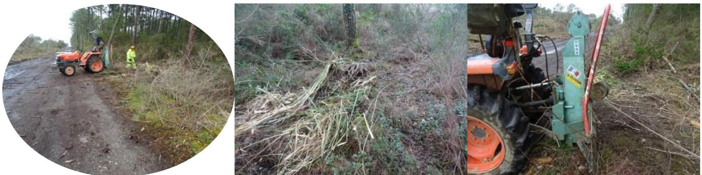
*Le tracteur en station sur le pare-feu ; un pied d'herbe de la pampa ramené par le treuil ; le treuil et son renvoi orientable.*
