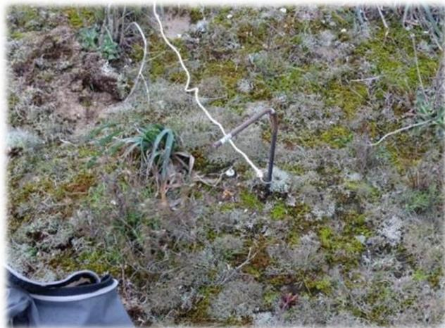
Le dispositif est constitué d'un fer à béton coudé, sur l'axe duquel coulisse via un anneau métallique une corde sur laquelle un nœud est fait à 2,52 m de l'axe. En tenant la cordelette tendue, et en s'alignant au départ avec la partie horizontale du fer à béton, on parvient à comptabiliser les pieds se trouvant dans l'emprise de l'aire de 20 m<sup>2</sup>. Le système s'est avéré pratique et facile à transporter.
